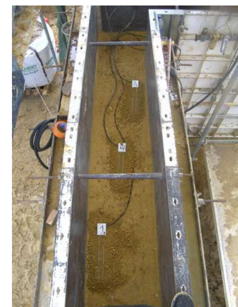
Maison de St-Antoine l'Abbaye : les sondes d'humidité relative et température (à gauche) et de teneur en eau (à droite) positionnées dans les murs en pisé.
