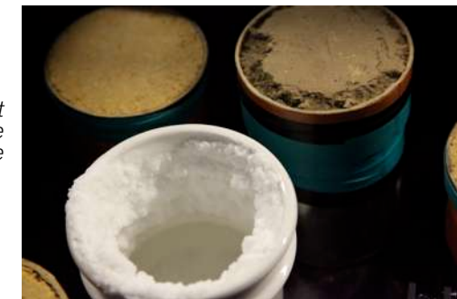
Échantillons de pisé et solution saline saturée pour mesure de flux de vapeur au LGCB.
